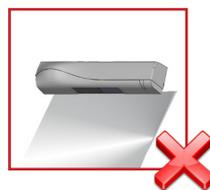
No coloque objetos muy reflectantes (espejos, objetos de acero inox.) en el rayos IR.
